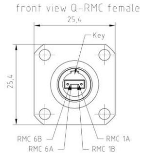
Alle Abmessungen in [mm]; Toleranzen nach ISO 2768 m-H
