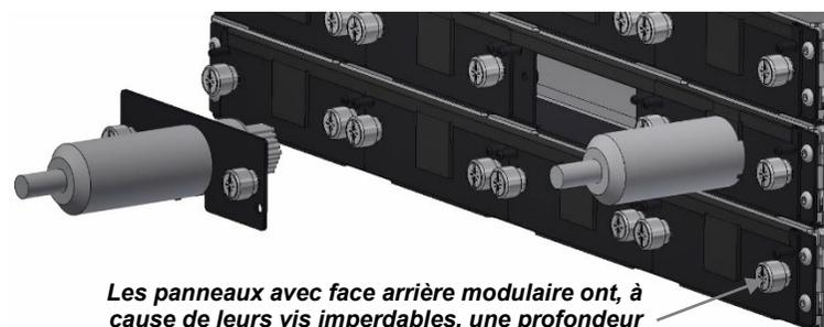
Les panneaux avec face arrière modulaire ont, à cause de leurs vis imperdables, une profondeur de 212 mm et 312 mm.
