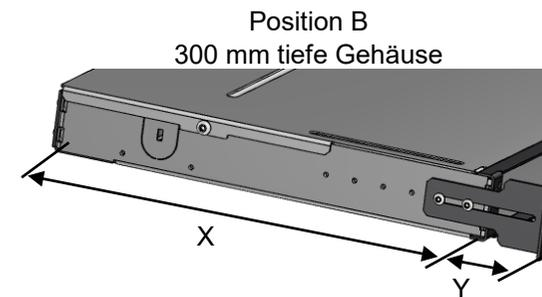
*2, 3 und 5 HE Gehäuse sind durch die unverlierbaren Schrauben ihrer Rückwand-Blindabdeckungen 212 mm und 312 mm tief. Das muß besonders bei der Position A mitberechnet werden, weil die Gehäuse in diesen Fällen X + 12 mm mehr Tiefe benötigen.*
