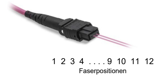
Die Faserpositionen im MTP® werden von der Seite mit dem weißen Punkt aus gezählt.
