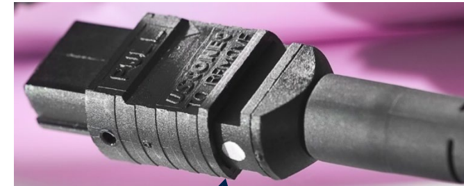
Die Faserpositionen im MTP® werden von der Seite mit dem weißen Punkt aus gezählt.
